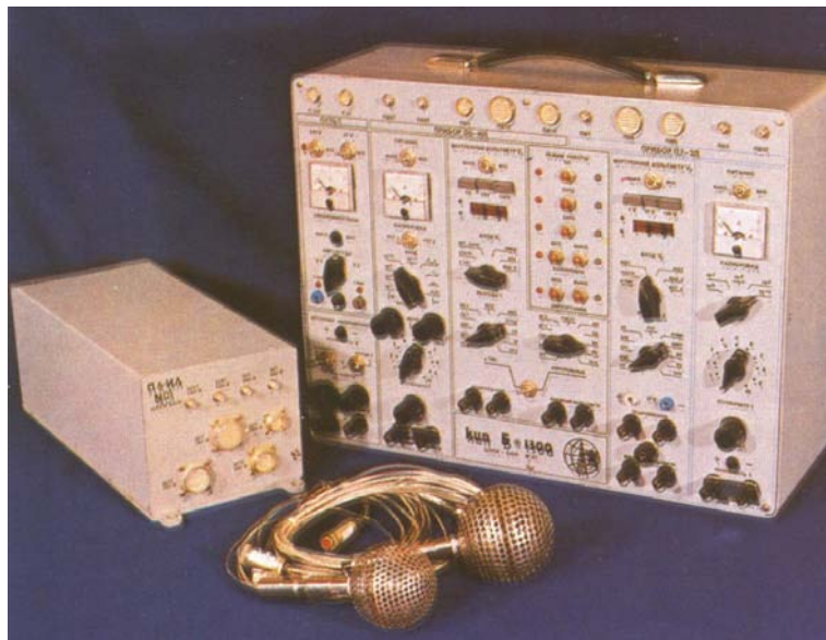
Фиг. 3. Комплексът научна апаратура на йонния уловител П6-ИЛ включва Блок електроника, два сферични датчика монтирани на щанги извън корпуса и КИП Б-1300 за приемо-предавателни изпитания
